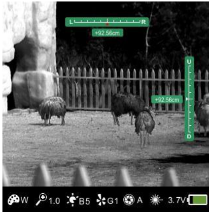
Obr. 7 Rozhraní nastavení zaměřovacího kříže
